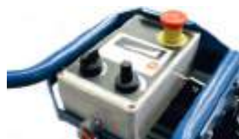
Display con indicazione della potenza e contatore di funzionamento
