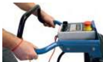
Interruttore di corrente per lavorare in sicurezza
