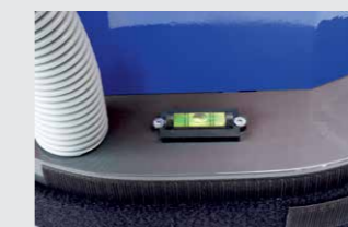
Wasserwaage zum Einstellen des Schleiftopfs, dadurch gleichmäßige Abtragsleistung am Boden.
