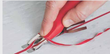
Nachschnitt mit ausgeschwenkter Distanzgabel
