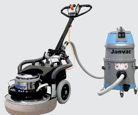
Abbildung zeigt Schleifmaschine SPEEDTRONIC mit Absaugsystem Multi-Vac und Janvac 1600
