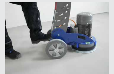
Mit Fussraste zum einfachen Kippen der Maschine
